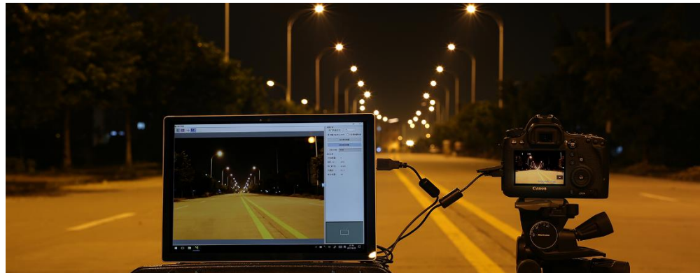
使用搭载佳能产品的眩光及光污染评估系统在道路场景中的应用
