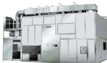
FPD (平板显示器) 曝光设备
