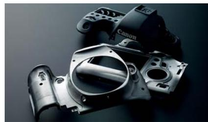
相机机身正面和背面外壳均采用轻量坚固的镁合金材料，为保持 Wi-Fi 通讯时良好的无线电穿透性，相机顶部采用了含有玻璃纤维的聚碳酸酯材料，而且施以了涂层提高了耐久性，从而实现了高强度和高品位。
