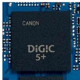
DIGIC 5+ 数字影像处理器可对约 2020 万像素的庞大信息进行高速处理,基于优秀的算法恰当降低噪点,是高画质和高感光度拍摄得以两全的关键部件。DIGIC 5+ 还承担着多种功能的计算,如自动调节被
