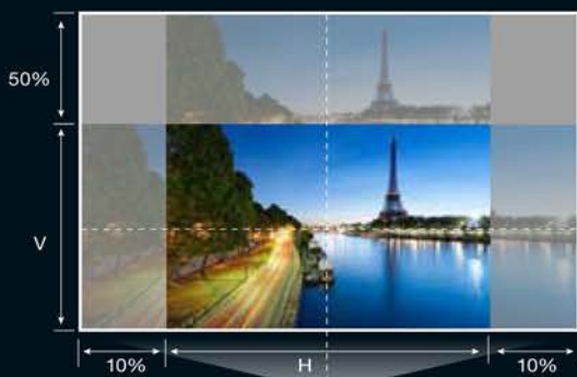
镜头可在垂直方向0%~50%、水平方向±10%范围内灵活移动
