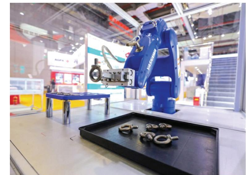
佳能3D机器视觉系统：以高速高精度的3D检测，识别散乱堆积的物件，提高生产线上物件供给和加工的效率
