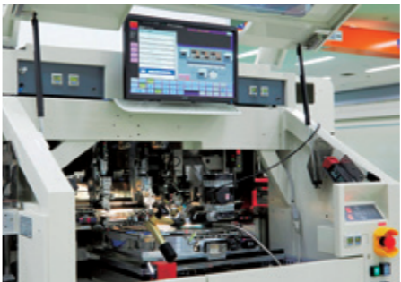
高速、高精度接合晶粒的佳能机械产固晶机
