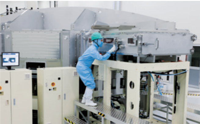
佳能特机生产的OLED面板制造设备
