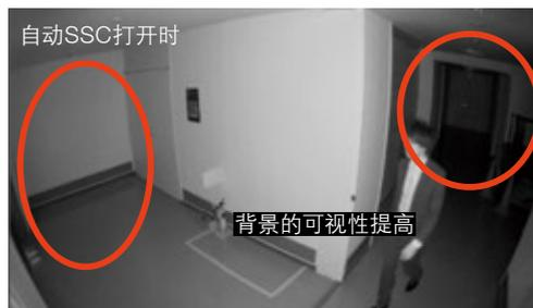
红外光照射的目标距离较近的时候，由于红外灯的自动调光功能，会存在背景变暗的现象。通过同时使用红外照明和自动SSC，会提高背景的可视性，使目标和背景能够同时明亮地拍摄。
