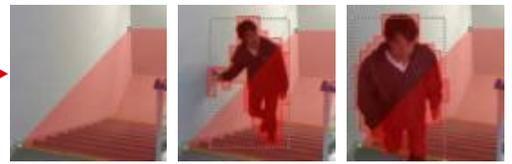
事件触发后探测区域的颜色浓度会发生变化
