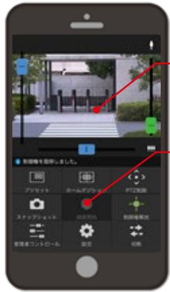
可以在画面上用手指滑动进行PTZ操作（也可以使用滑动条操作）
